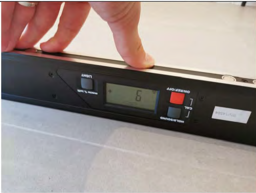
Фото №23. Измерение уровня пола в коридоре. Отклонение составляет 6 мм.
