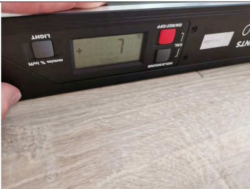
Фото №21. Измерение уровня пола в спальне.
