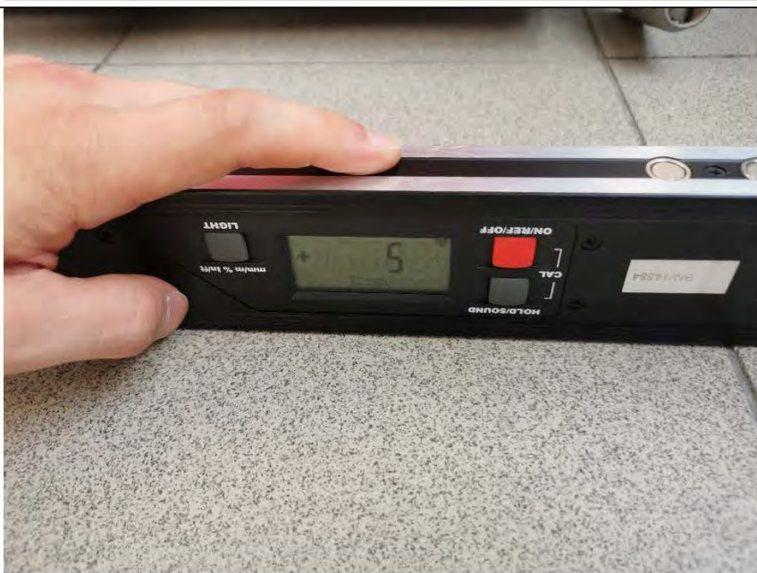
Фото №24. Измерение уровня пола в лоджии. Отклонение составляет 5 мм.
